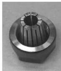
Inséré le collet dans l'écrou avant de mettre votre mèche
